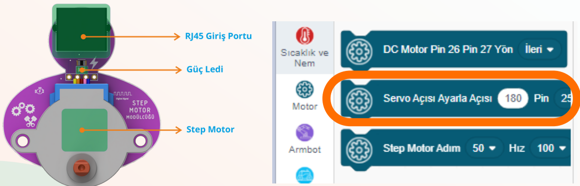
Resim 14 - Step Motor Modülü Üst Görünüş ve Codlai Editör Step Motor Modülü Blokları
