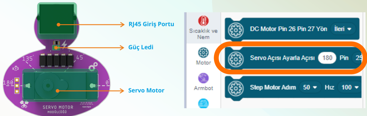
Resim 11 - Servo Motor Modülü Üst Görünüş ve Codlai Editör Servo Motor Modülü Blokları
