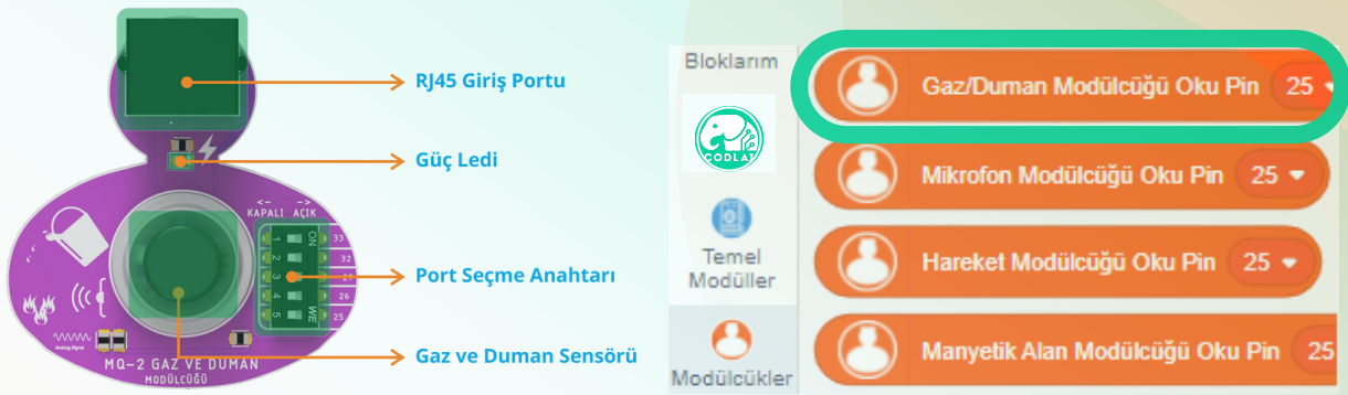
Resim 3 - Gaz ve Duman Modülü Üst Görünüş ve Codlai Editör Gaz ve Duman Modülü Blokları
