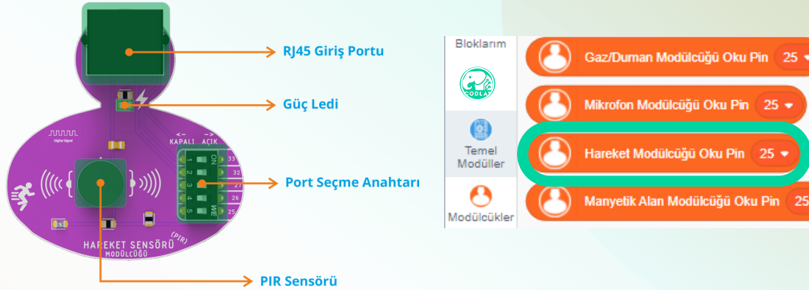
Resim 9 - PIR Sensör Modülü Üst Görünüş ve Codlai Editör PIR Sensör Modülü Blokları
