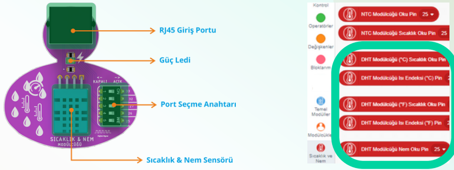
Resim 13 - Sıcaklık ve Nem Modülü Üst Görünüş ve Codlai Editör Sıcaklık ve Nem Modülü Blokları
