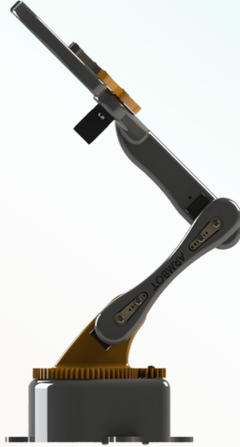
Resim 15 - Dirsek Kalibrasyon Pozisyonu
